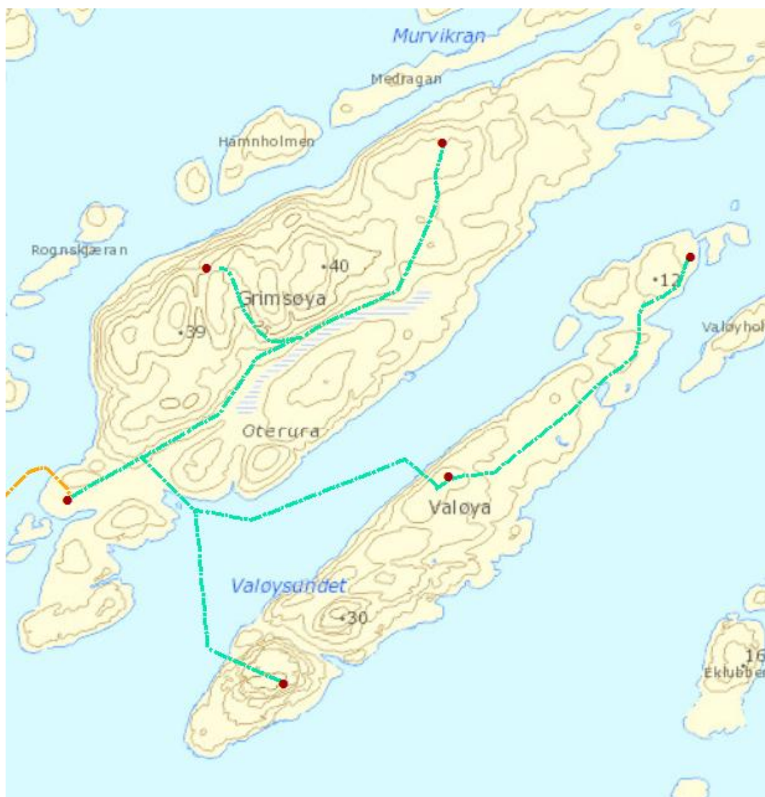
Figur 4.5. Forslag til internt kabelnett (jord- og sjøkabel).
