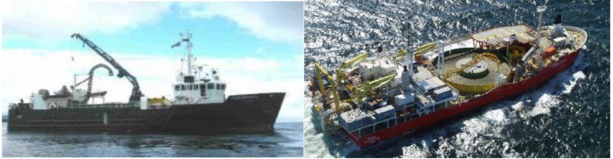
Figur 4.4. Kabelleggingsfartøy, hhv. CV Fjordkabel (Seaworks AS) og C/S Nexans Skagerarak 2 (Nexans Norway AS)
